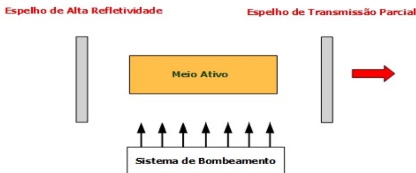
Figura 1 – Sistema típico de um laser, mostrando o meio ativo, o sistema de bombeamento e a cavidade ótica.
