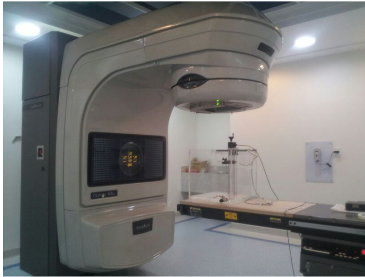
Figura 3.7: Acelerador linear, mesa de tratamento, câmara de ionização e fantoma.
