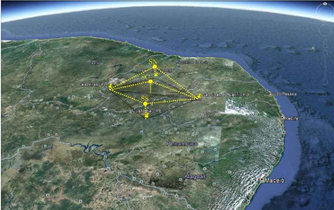
Figura 0.11 - Ilustração dos Setores de observação Norte, Sul e central. Onde as linhas amarelas representam as linhas de visada dos interferômetros e as linhas pretas representam as projeções das linhas amarelas no solo.
