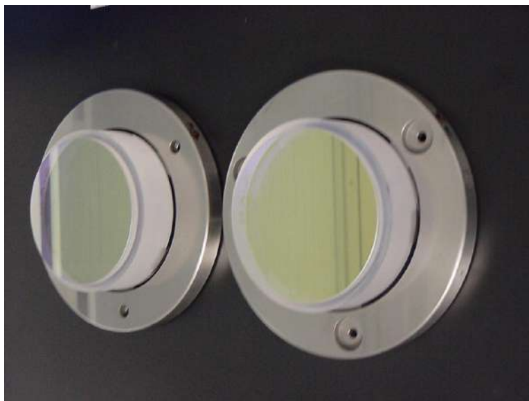
Figura 0.4 - Foto das Placas planas transparentes com uma superfície refletora com 77% de refletividade de um IFP.
